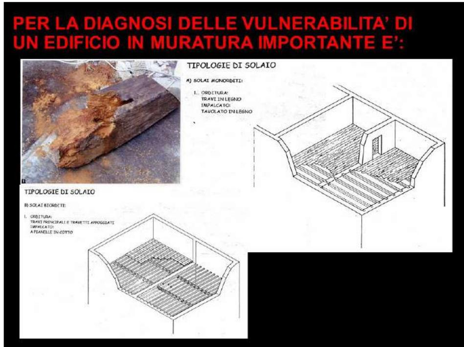
Vengono quindi elencate delle costruzioni in muratura ed in cemento armato le principali tipologie di fondazione, delle strutture verticali, orizzontali ed oblique; e quindi per ognuna di esse i principali elementi diagnostici e di criticità.
